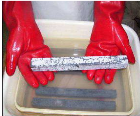
Fotografía 2: Fisuración en la barra de mortero
