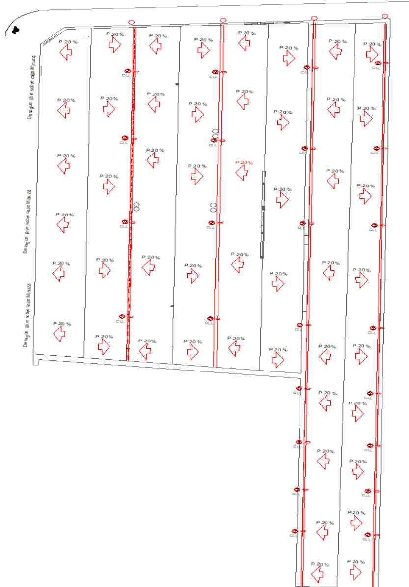
Figura 32 Planta desagües pluviales
