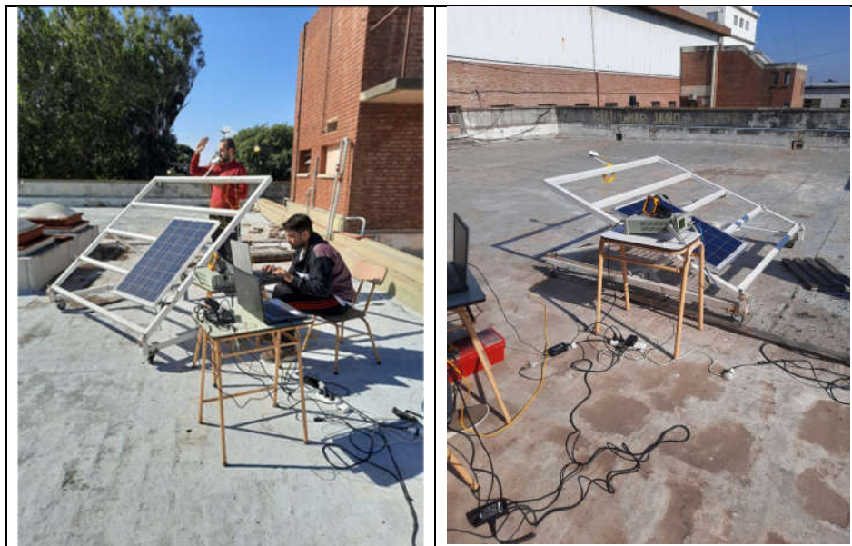
Figura 2. Plataforma ajustable para ensayos de paneles fotovoltaicos.
