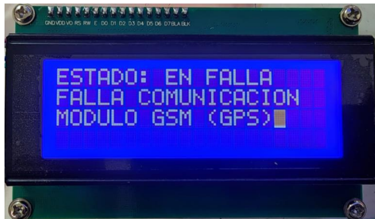
Figura 66. Mensaje de falla en comunicación
