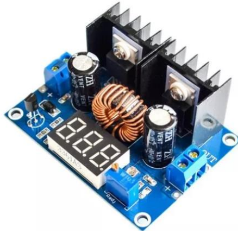
Figura 44. Convertidor DC/DC buck
