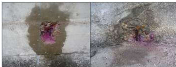
Figura 11: Ensayo y medición de carbonatación con fenolftaleína
