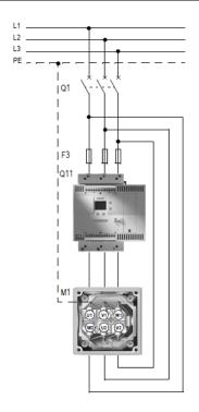
Imagen 6.6: Conexión de las protecciones.
