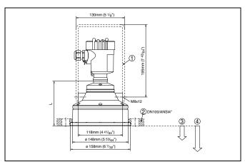
Tab. 29: VEGASON, Medida L para carcasa de aluminio = 108 mm (4.252"), medida L para carcasas plásticas y de acero inoxidable = 114,5 mm (4.508")
