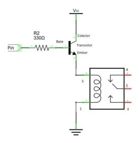
Imagen 7.28: Esquema de conexión de relé a arduino
