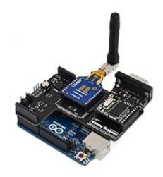
Imagen 7.21: Módulos de comunicación montados.
