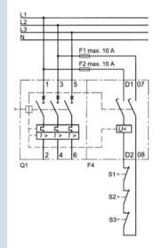
Los disparadores de mínima tensión con contactos auxiliares de acción adelantada impiden el arrastre de potencial en el mando con el interruptor en posición "OFF" En la posición de disparo "tripped" de los interruptores automáticos no está garantizada
