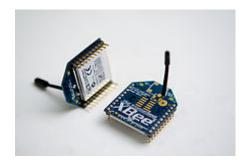
Imagen IV.22: Módulo XBee
