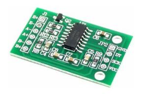
Imagen 7.35: Transmisor de celda de carga HX771
