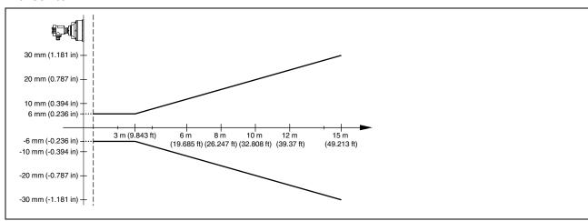
Tab. 23: Error de medición VEGASON 63
