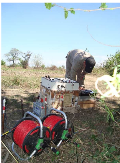
Figura 1. Trabajo de campo de la prospección geoelectrica
