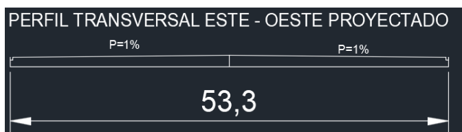
Figura 38: Plano Corte – Perfil transversal proyectado. Fuente: Propia.
