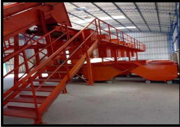
Figura 18: Foto vista interior de la planta de tratamiento – Cinta Transportadora. Fuente: propia.
