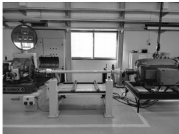
Figura 2. *Ensayo del acoplamiento al dinamómetro (vista lateral)*
