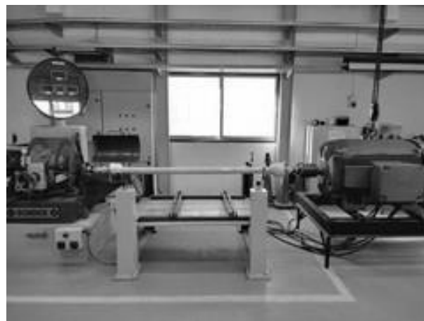
Figura 2. Ensayo del acoplamiento al dinamómetro (vista lateral)
