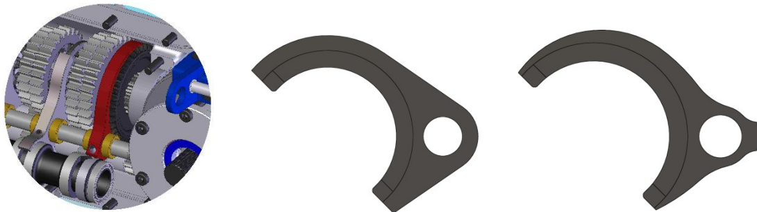
Figura 1: Topología obtenida, volumen final con rediseño de horquilla Fuente: elaboración propia.
