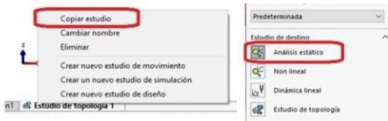
Figura 16 Configuración del análisis estático
