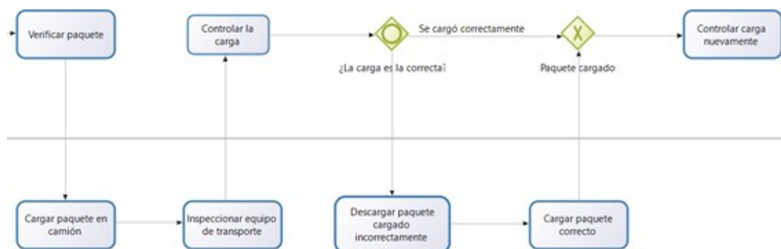
Figura 4 Lane del supervisor de depósito (parte superior) y del personal de carga (parte inferior).
