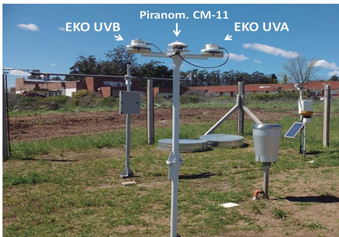
Fig. 1. Instrumental instalado en el nodo Tandil de Saver-Net: EKO-UVB, EKO-UVA y piranómetro Kipp&Zonen modelo CM-11)
