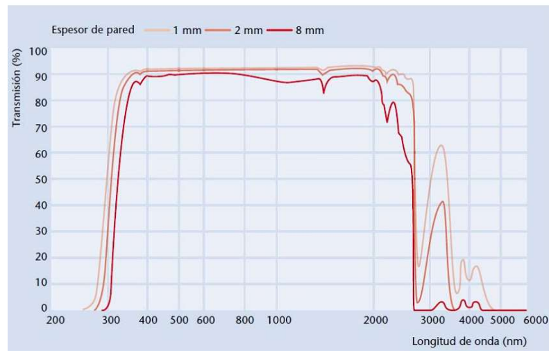
Figura 9-43: Transmisividad del vidrio borosilicato 3.3 para diferentes espesores. Referencia www.schott.com .
