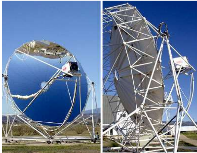
Figura 9-39: Concentrador paraboloide de revolución con un motor Stirling en la plataforma solar de Almería. Referencia [78].
