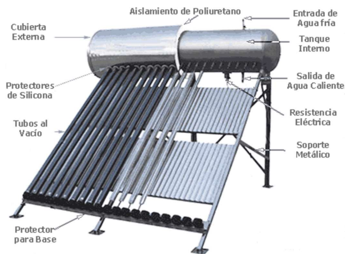
Figura 5-8: Un colector plano formado por tubos de vacío. Referencia [36].
