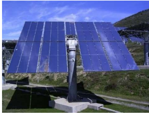
Figura 9-31: Un helióstato con los espejos formados por facetas. Referencia [77].
