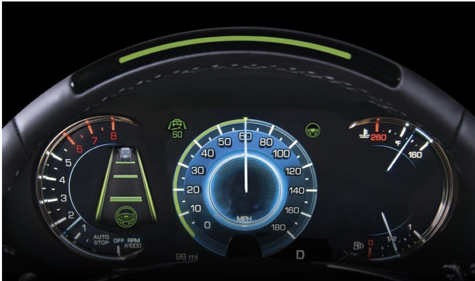
Figura 3 - Primer Alerta del sistema Super Cruise 3
