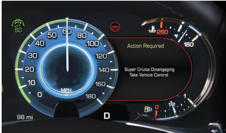
Figura 5 – Tercera Alerta del sistema Super Cruise 5
