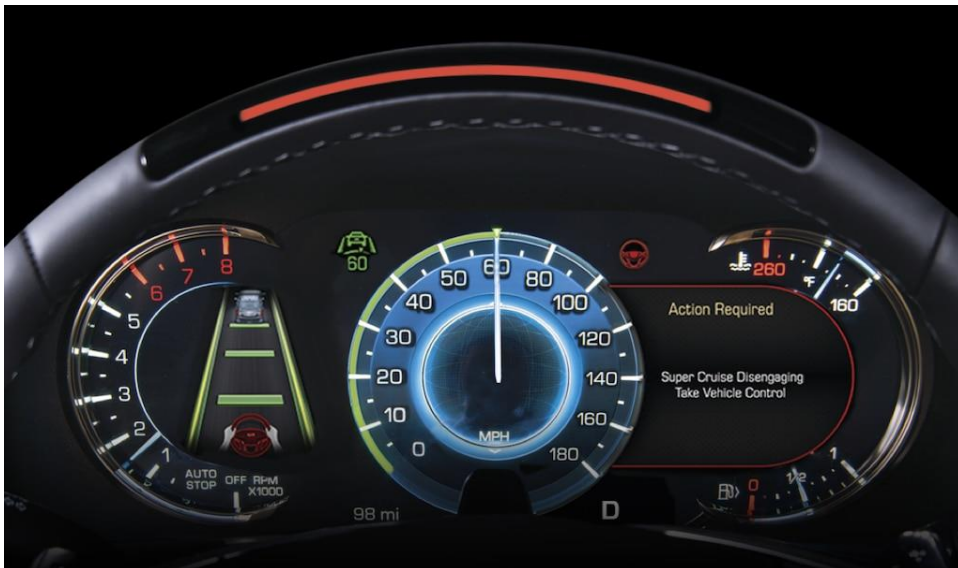
Figura 4 – Segunda Alerta del sistema Super Cruise 4
