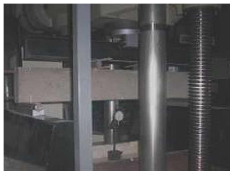
Figura 2: Ensayo a flexión: esquema de ensayo e instrumentación
