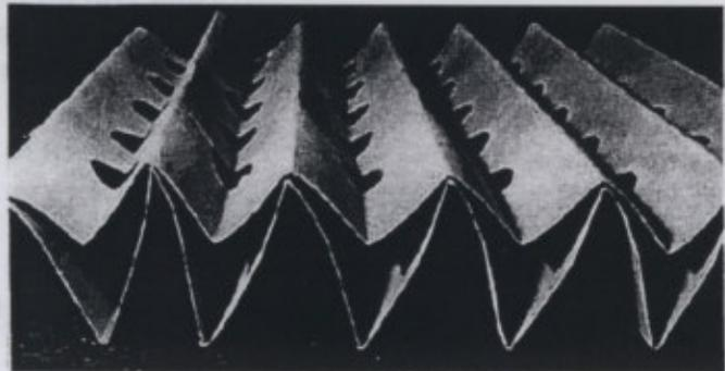
En cada una de las celdas, la disposición de los agujeros de la celda provoca un efecto Venturi o de ciclón que obliga a las partículas de pintura a depositarse en el fondo de la celda. La alta eficiencia de la separación proviene del efecto Venturi donde la inercia de las partículas se combinan con importantes variaciones locales de velocidad y de dirección al interior de la celda.
