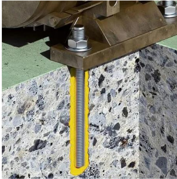
Figura 61. Esquema de anclaje químico.
