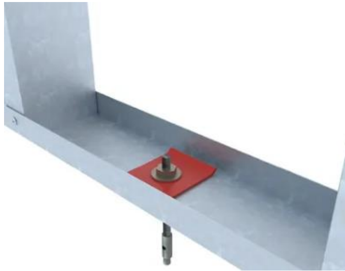
Figura 59. Esquema de anclaje mecánico.
