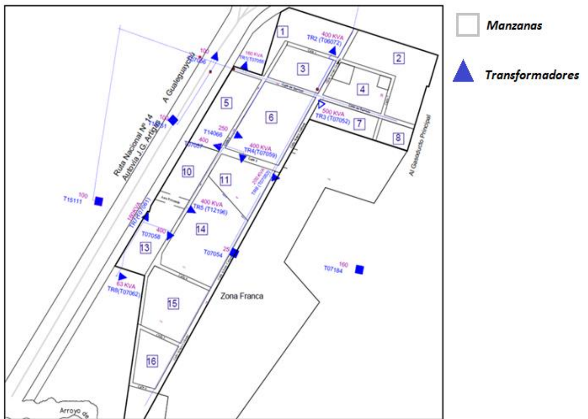
Figura 1-IB: Ubicación de transformadores en PICU
