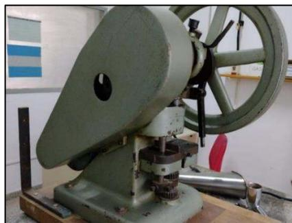
Fig. 1 – Prensa compactadora de tabletas monopunzón.
