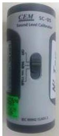
Figura 3: Calibrador
