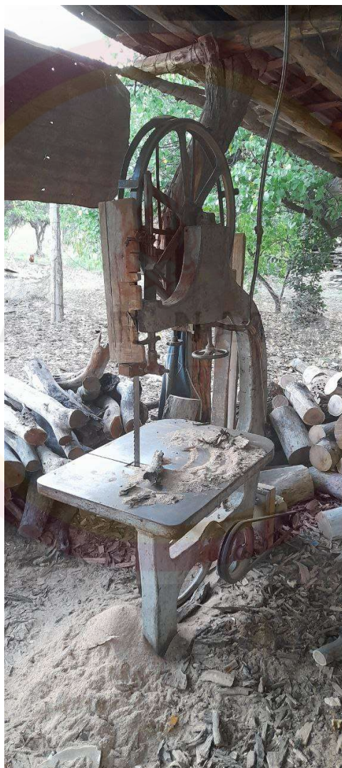
Imagen N° 7 Sierra sin fin utilizada para trozar troncos
