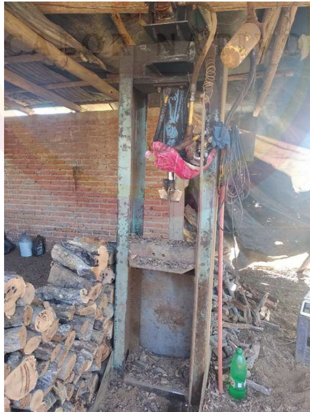
Imagen N° 13 - Prensa hidráulica con cuña
