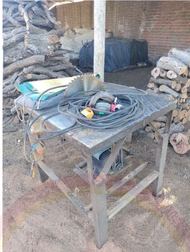
Imagen N° 12- Sierra circular utilizada para cortar troncos
