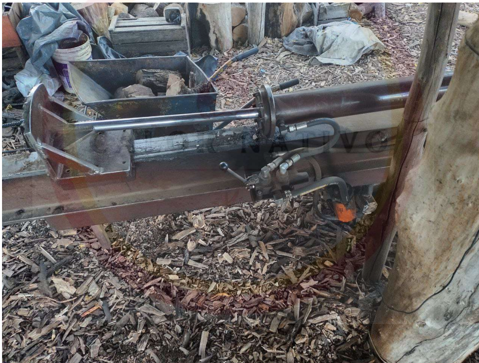
Imagen N° 8 Cilindro Oleo-hidráulico utilizado para partir troncos
