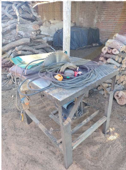
Imagen N° 4 Sierra circular utilizada para cortar leña
