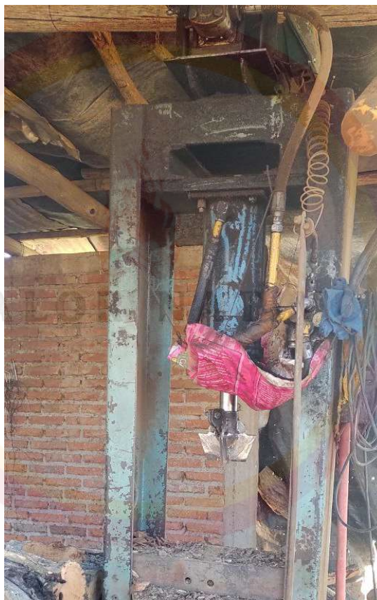
Imagen N° 5 Prensa hidráulica para trozar leña
