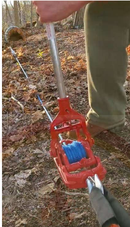
Imagen N° 21- Malacate siendo utilizado para el traslado de troncos
