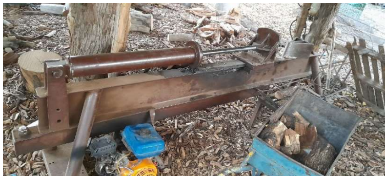
Imagen N° 14 - Cilindro hidráulico utilizado para astillar madera
