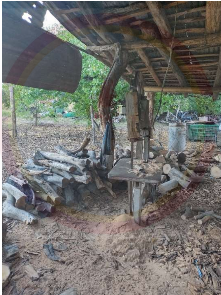
Imagen N° 11- Sierra sin fin utilizada para cortar troncos
