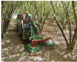
Recolección mecanizada (hileradora+recolectora)
