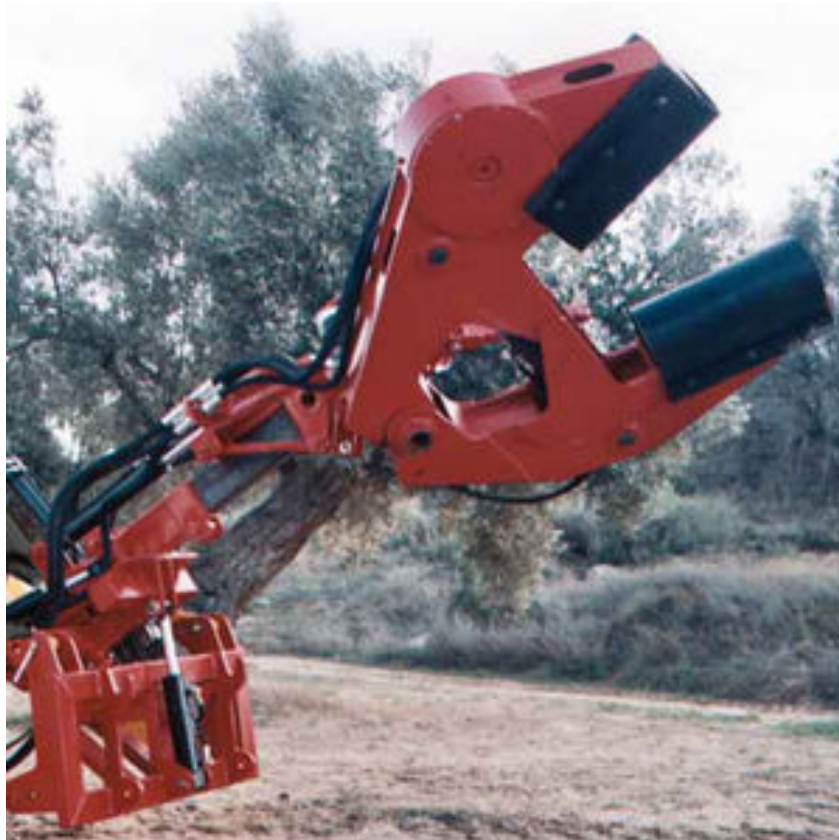
Fig.4: Cabezal de shaker tipo pinza.
