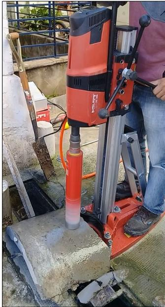
*Figura 1: Extracción de testigos calados.*
