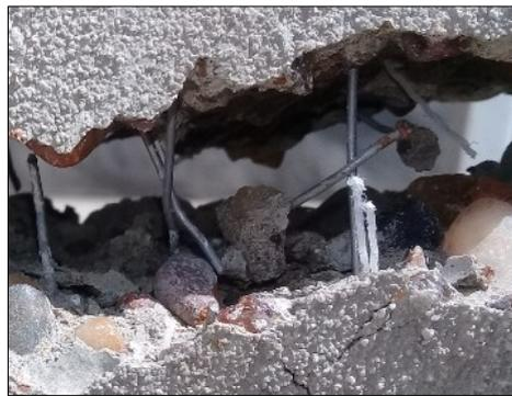
*Figura 5: Imagen ampliada de la grieta del tubo luego de la rotura. Se observan fibras de acero arrancadas y fibras de polipropileno cortadas.*
