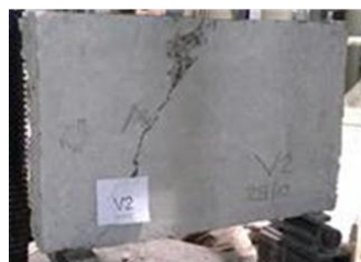
Figura 4 – Modos de falla de las VGA: a) Viga V2 sin fibras, con estribos; b) Viga de HRFA, V664
