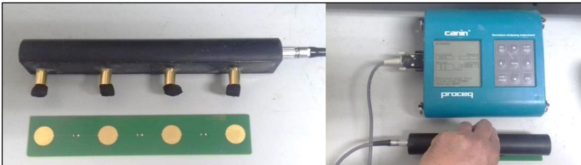
Figura 5 Sonda de Wenner. Calibración del dispositivo
