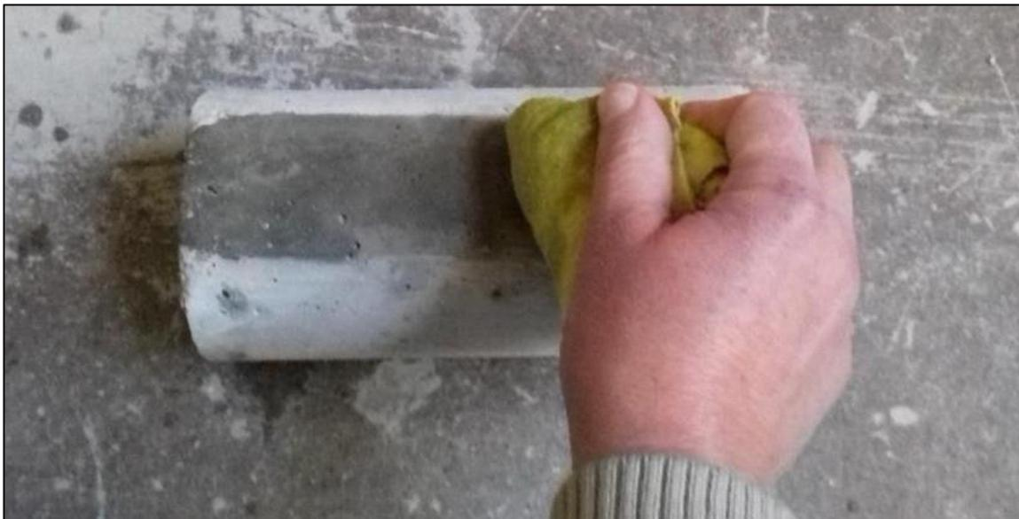
Figura 6 Humedecimiento de la superficie del hormigón a medir
