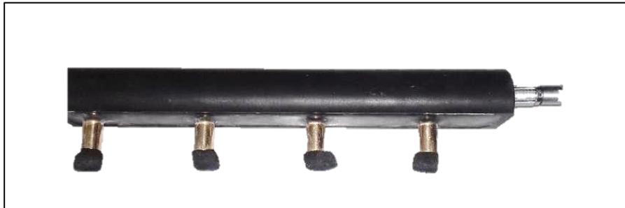
Figura 3 Sonda de Wenner para medir resistividad
