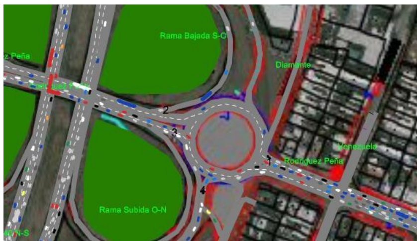
Figura 63. Modelación Situación 2037 con Proyecto Rotonda. Fuente: Elaboración Propia, imagen Software VISSIM
