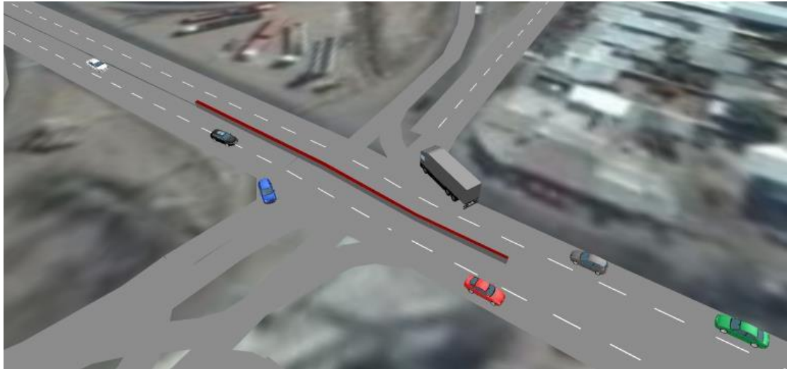
Figura 64. Separador Rígido sobre Rodríguez Peña intersección Calle Diamante. Fuente: Elaboración Propia, imagen Software VISSIM
