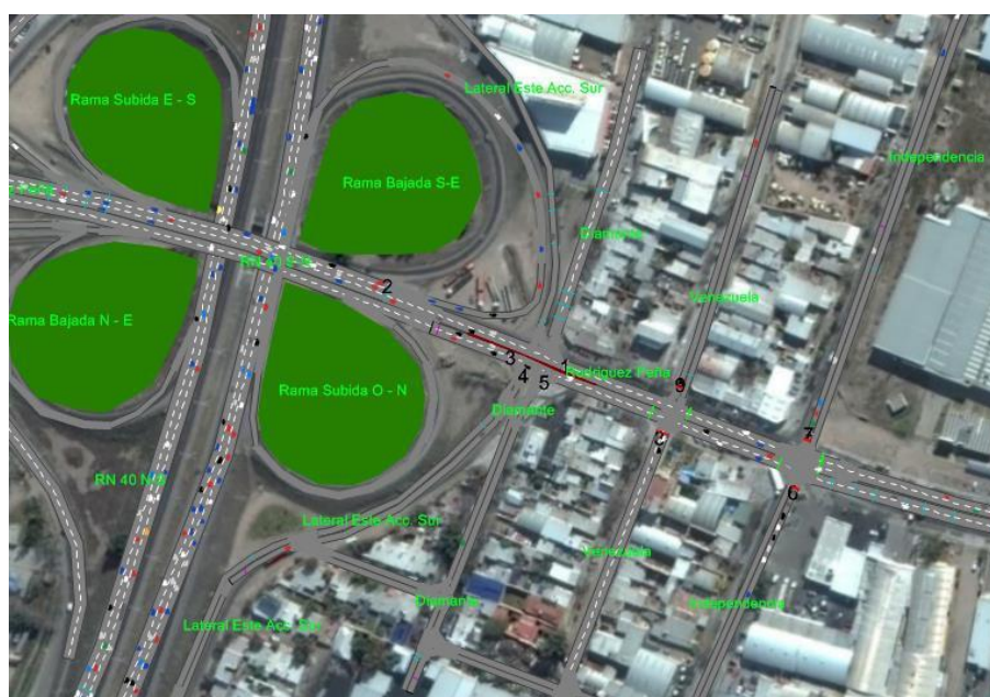
Figura 69. Separador Rígido sobre Rodríguez Peña, aumento de longitud de Rama de bajada RN N°40 (Acc. Sur), incorporación de 3° carril y apertura Calle Venezuela año 2017.
