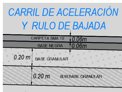
Figura 98. Perfil Estructural Carril de Aceleración Rulo sobre Rodriguez Peña y Rulo de Bajada Acceso Sur. Fuente: Elaboración Propia
