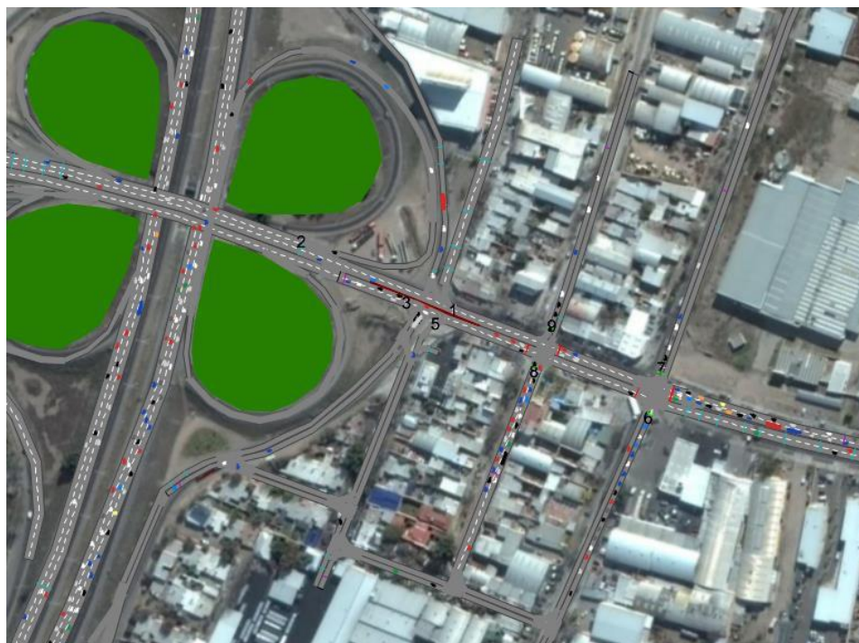
Figura 71. Separador Rígido sobre Rodriguez Peña, aumento de longitud de Rama de bajada RN N°40 (Acc. Sur), incorporación de 3ª carril y apertura Calle Venezuela año 2037. Fuente: Elaboración Propia, imagen Software VISSIM
