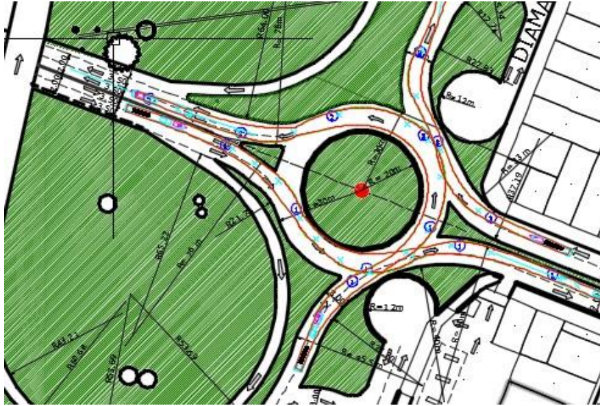
Figura 62. Radios de giro para camión tipo WB-19. Fuente: Adaptado de Vehicle Tracking Autodesk
