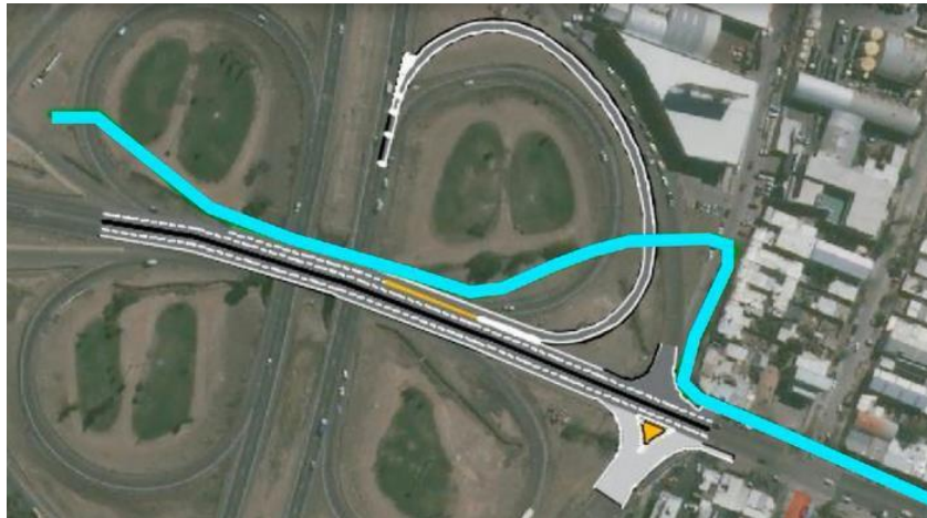
Figura 92. Ciclovia planteada en Red de Estudio. Fuente: Elaboración propia, utilizando software AutoCAD Civil 3d
