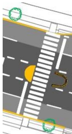
Figura 106. Propuesta de Mejoras de isletas peatonales. Fuente: Elaboración Propia utilizando Software AutoCAD
