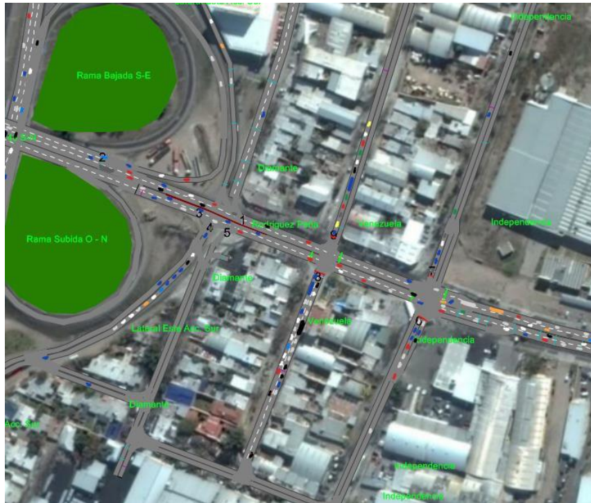
Figura 74. Separador Rígido sobre Rodríguez Peña, aumento de longitud de Rama de bajada RN N°40 (Acc. Sur), incorporación de 3°Carril y apertura Calle Venezuela + 3°Carril en Calle Independencia año 2037. Fuente: Elaboración Propia, imagen Software VISSIM
