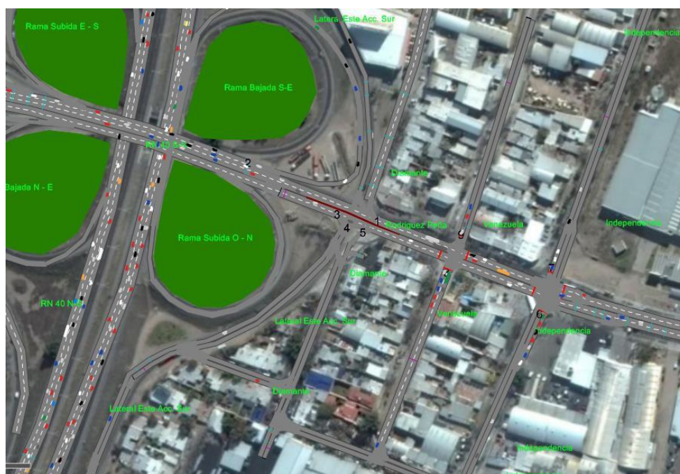
Figura 73. Separador Rígido sobre Rodriguez Peña, aumento de longitud de Rama de bajada RN N°40 (Acc. Sur), incorporación de 3°Carril y apertura Calle Venezuela + 3°Carril en Calle Independencia año 2017. Fuente: Elaboración propia, imagen Software VISSIM.
