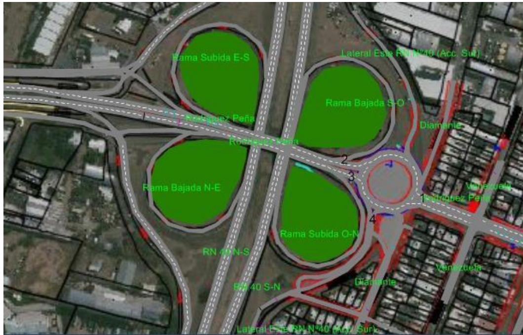
Figura 59. Situación con proyecto – Modelación de Tránsito. Fuente: Elaboración Propia, imagen software VISSIM
