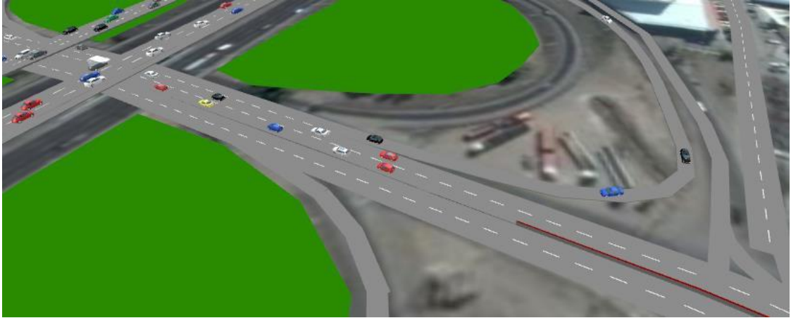
Figura 66. Separador Rígido sobre Rodríguez Peña, aumento de longitud de Rama de bajada RN N°40 (Acc. Sur), incorporación de 3°Carril. Fuente: Elaboración Propia, imagen Software VISSIM
