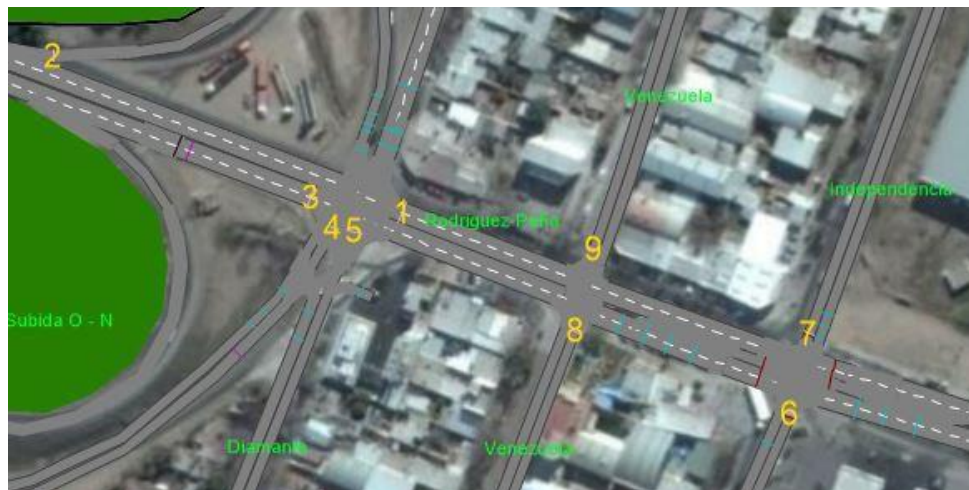
Figura 51. Ubicación de contadores de longitudes de Colas máximas. Fuente: Elaboración propia, imágenes VISSIM
