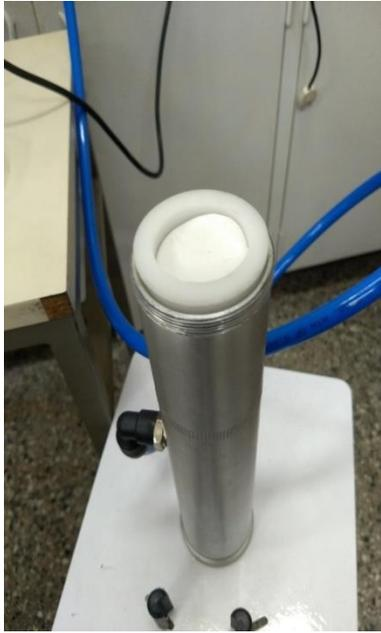
**Figura 5 – Colocación de Papel Filtro en Impactador**
