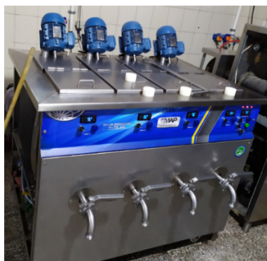
Figura 4.2.4: Tina de maduración con recipiente rectangular abierta
