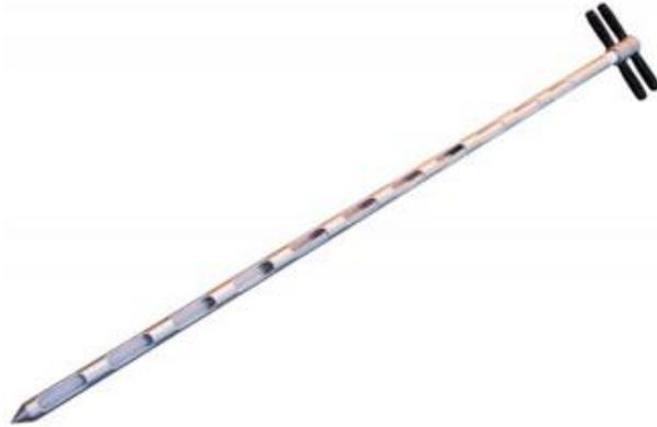
*Ilustración 12- Calador Sonda Manual.<sup>6</sup>*
