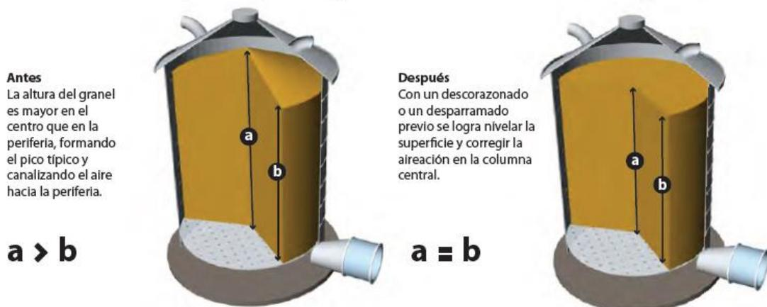
*Ilustración 6- Nivelado de silos*
