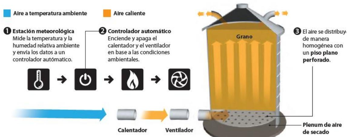
*Ilustración 4- Sistema de secado con baja temperatura.*
