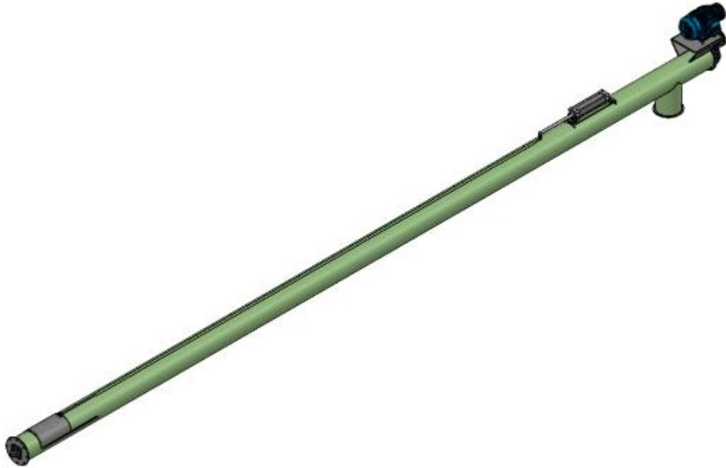
*Ilustración 18- Transporte Helicoidal.*
