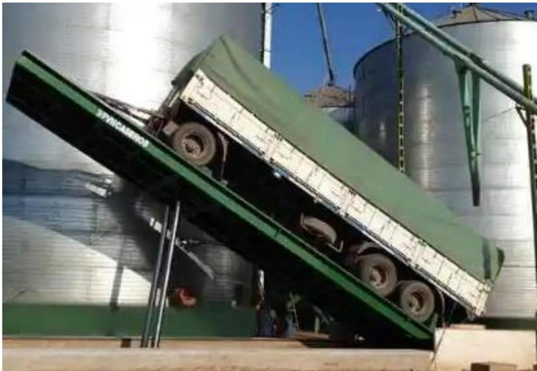
*Ilustración 14- Plataforma volcadora hidráulica.<sup>8</sup>*
