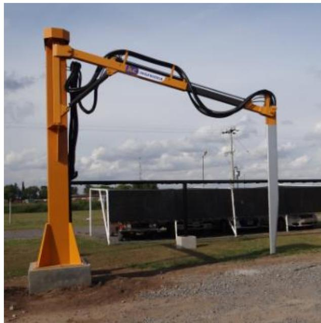
*Ilustración 13- Calador Automático.<sup>7</sup>*
