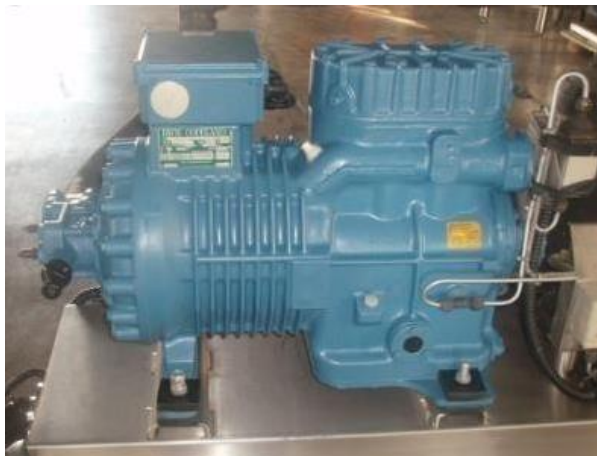
Ilustración 30: Compresor de frío
