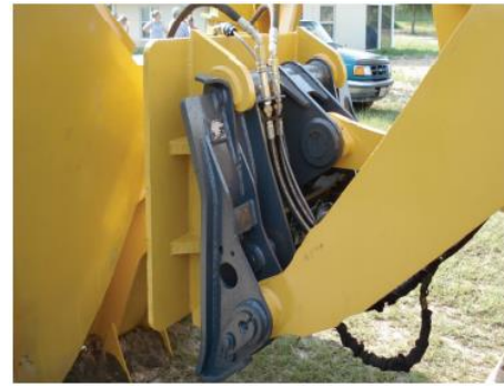
Imagen N°72: Enganche rápido del lado del brazo en pala para árboles de gran tamaño.
