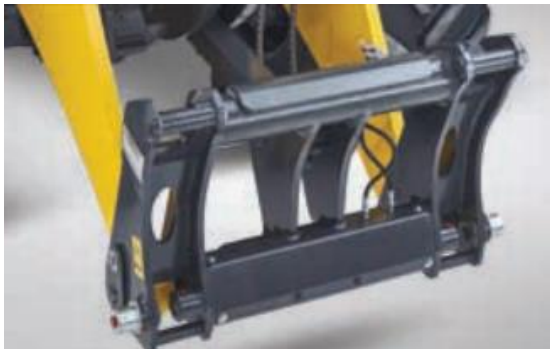
Imagen N°72: Enganche rápido del lado del brazo en pala para árboles de gran tamaño.
