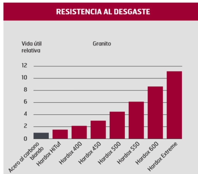
Imagen N°34: Comparación de vida útil para distintos tipos de aceros.
