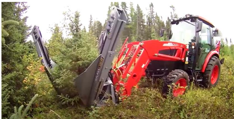
Imagen N°1: Máquina de trasplante acoplada al tractor mediante enganche en brazo.
