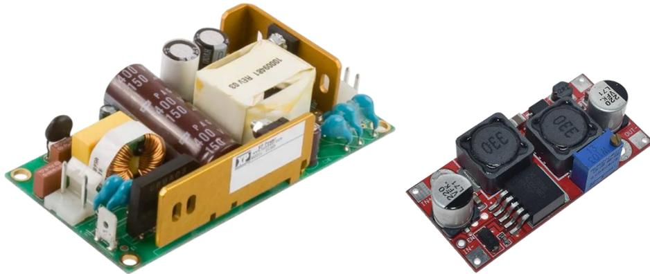
Figura 68 – Fuente de alimentación y Step-down/Step-up XL6009
