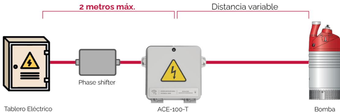
El equipo funciona bajo la modalidad “plug and play”, por lo que una vez conectado al tablero de alimentación de 380 Vac, empezará a registrar los datos de cantidad de horas de funcionamiento y parámetros de calidad de energía en el momento en que la bomba electrosumergible comience a funcionar, sin la necesidad de realizar ningún otro paso extra.
