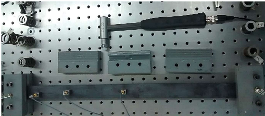
Figura A11.1– Setup experimental - Montaje de los acelerómetros.
