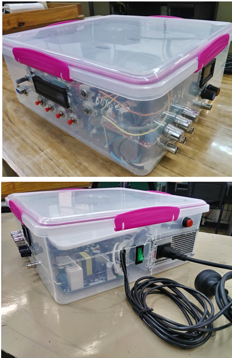
Figura A10. 36- Fotos del segundo sistema generación y amplificación de señales para shakers.
