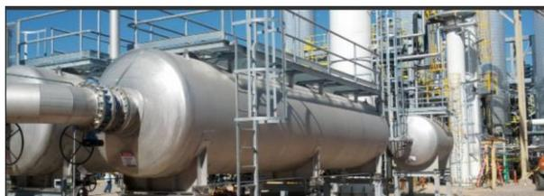
Figura 11.3: Filtros de carbón activado.
