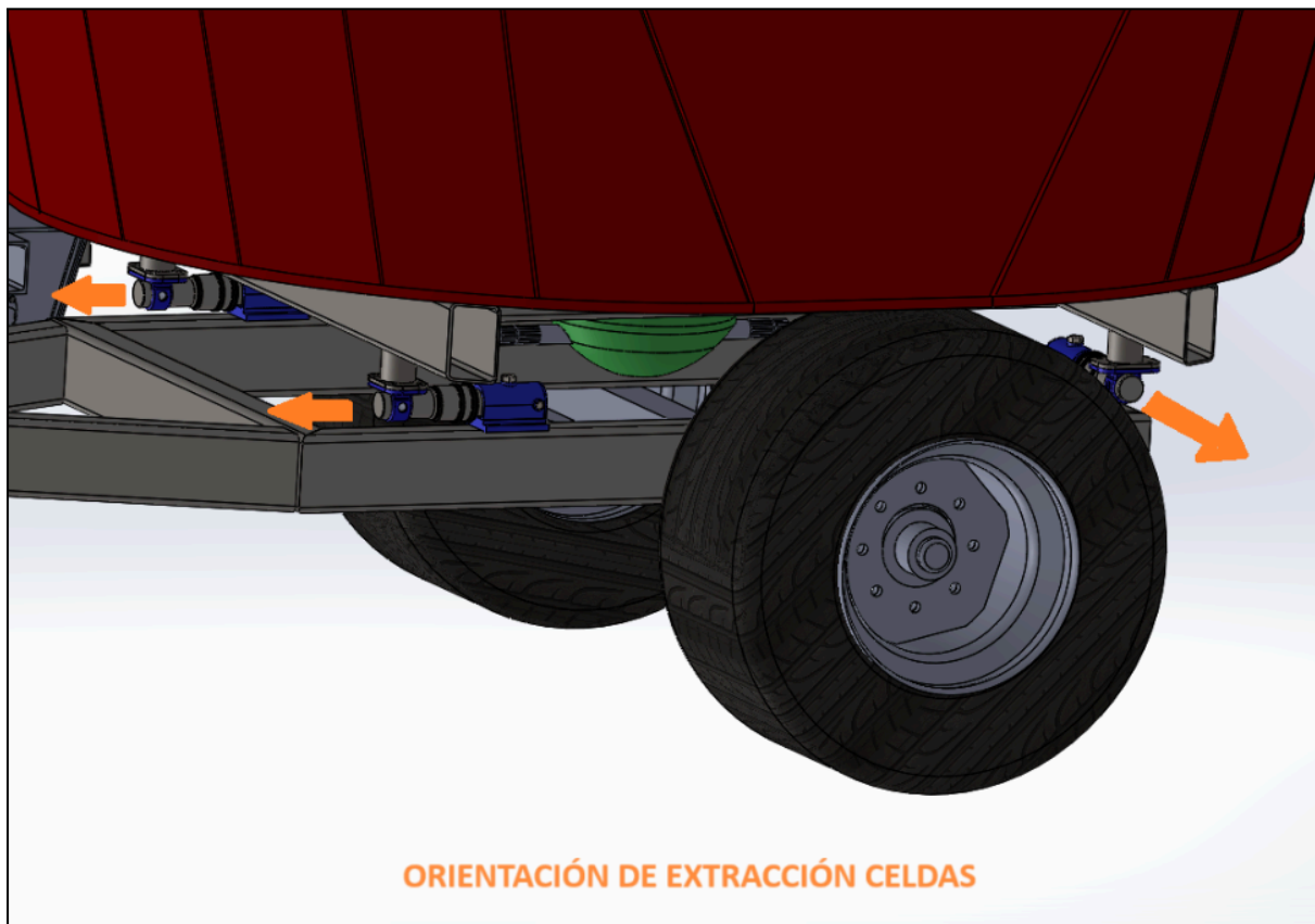
Fig. 72 - Modo de extracción de las celdas de carga
