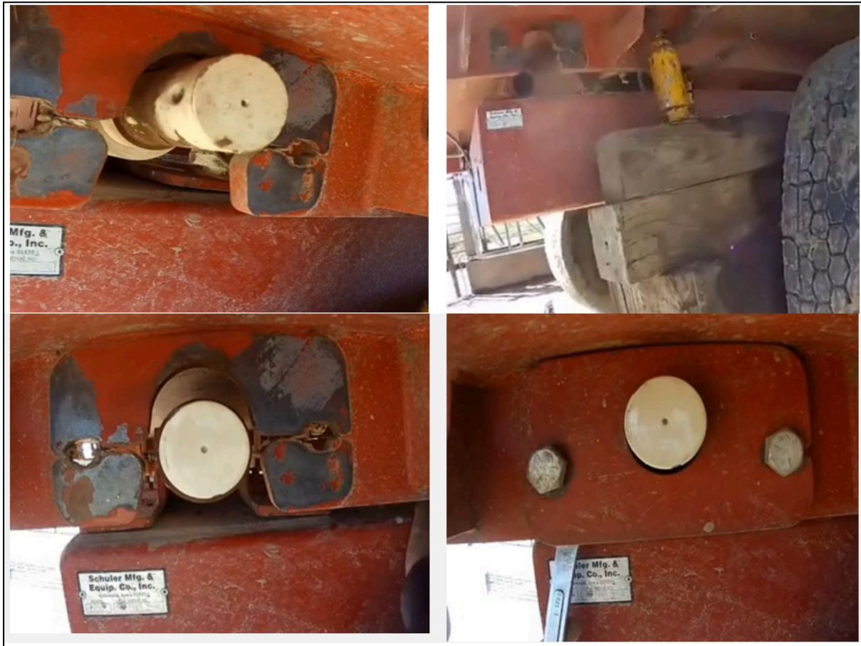
Fig. 68 - Recambio de celda tipo viga en un mixer
