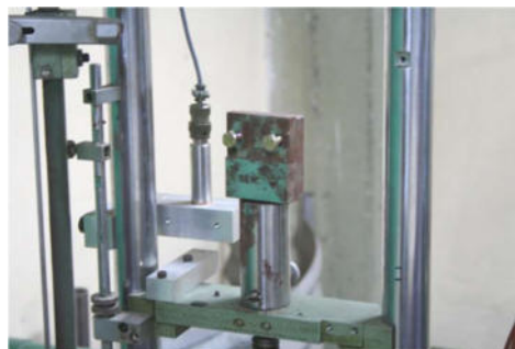
Figura 6: Transductor LVDT montado en la máquina de ensayos.
