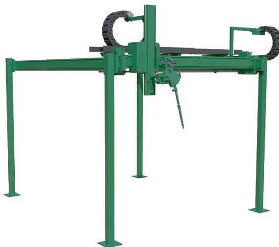
Figura 3. Sistema de Soldadura Automática de aplicación antidesgaste a superficies planas.
