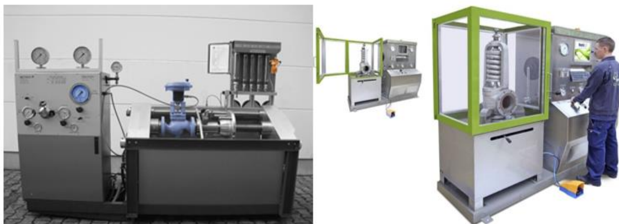
Figura 4. Banco de prueba de válvulas, marca Ventil (izquierda) y Kalmia (derecha).
