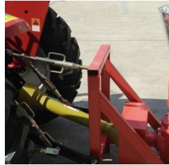
Motor eléctrico o Tracción por acople a vehículo agrícola
