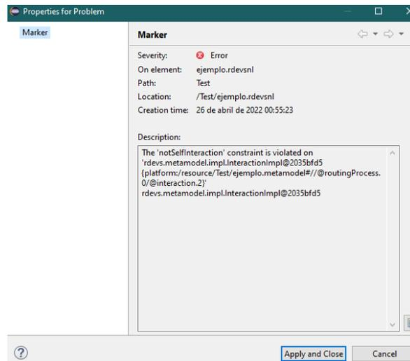
**Fig. 12.** Propiedades del error que fue mostrado en la Vista *Problemas* de Eclipse, en este caso originado al modificar la línea 11 de la especificación de la Figura 6 por “*The output of Machine3 is connected to the inputs of Machine3*”. Por la restricción  $v$ ) presentada en la Figura 4, esta situación no es admitida.
