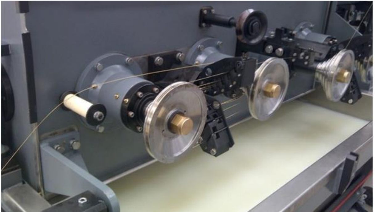
Interior de la máquina de trefilado de alambre JACOM. Imagen extraída el 22 de mayo de 2022. https://jacomgroup.com/trefiladora-de-alambre/
