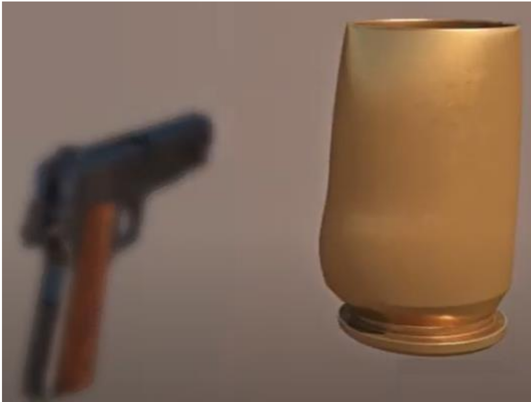
Figura 3. “Abultamiento en la base de la vaina, producto del disparo”.
