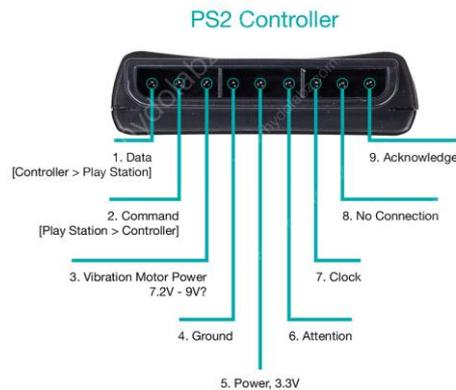
Figura 4-37. PinOut del receptor.
