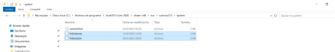
Teniendo ya las modificaciones realizadas acorde a nuestro proyecto, en conjunto la malla creada y compatible con OpenFOAM, [cerraremos para view](#), nos encontramos en condiciones de ejecutar el solver con el comando en el terminal de OpenFOAM “InterFOAM” (como se pudo visualizar en el block “controlDict”) este solver es el utilizado para modelaciones hidraulicas.
