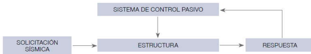
Figura 2.11. Esquema mecanismo de operación de sistemas pasivos.
