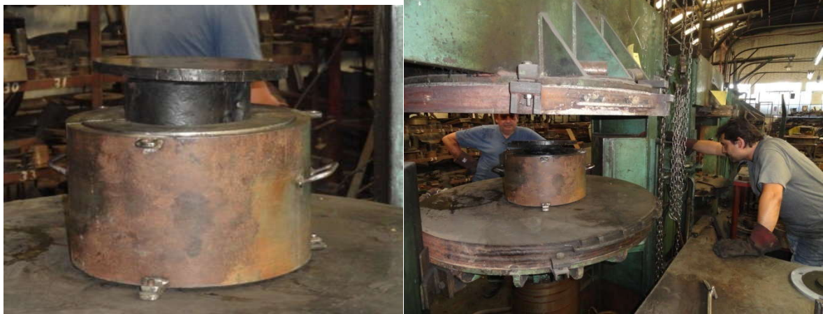
Figura 4.19. Fotografías previas al proceso de vulcanizado de los prototipos.
