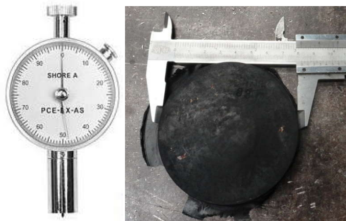
Figura 4.9. Durómetro tipo A y probeta del compuesto ensayado.
