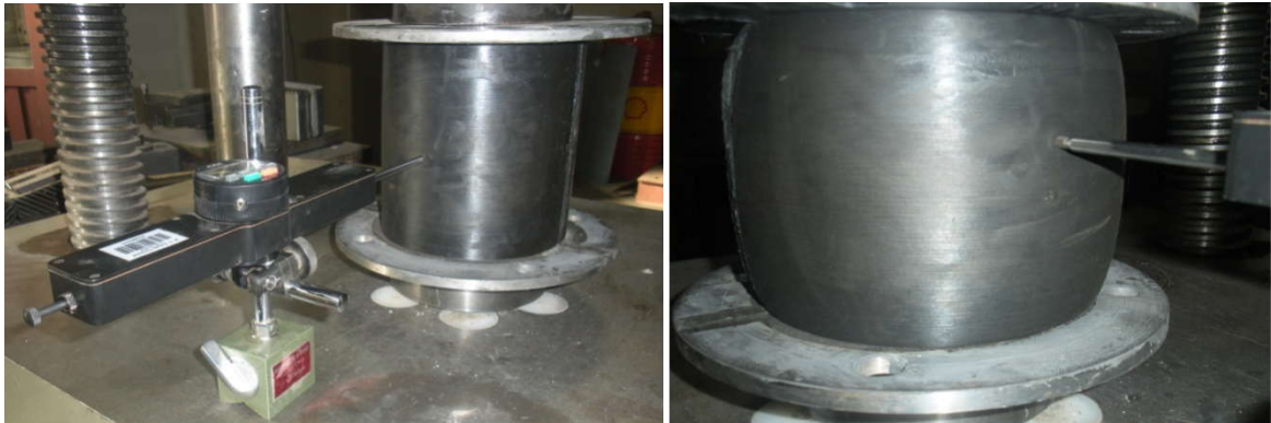
Figura 5.2. Fotografías del ensayo a fuerza axial vertical al prototipo ASNC-1.
