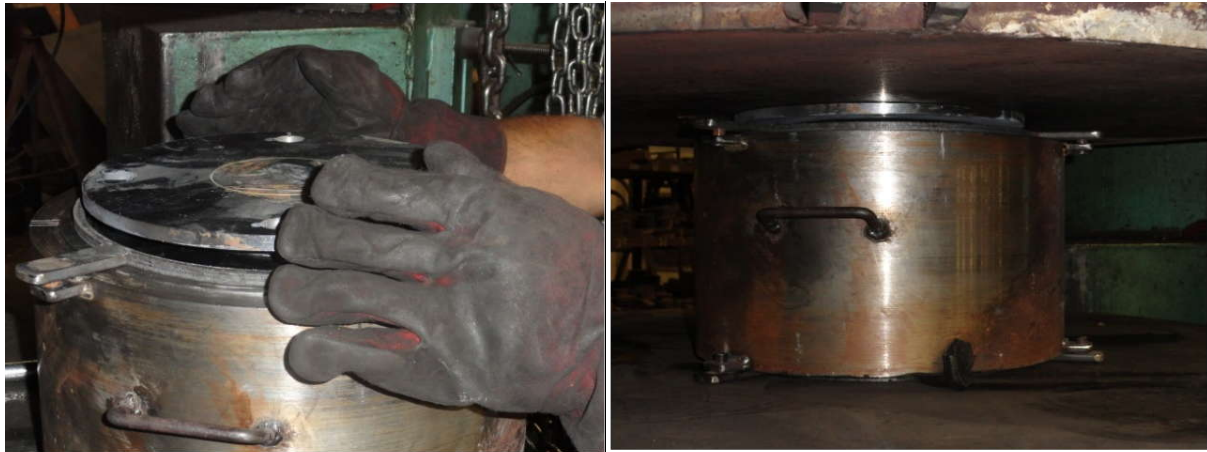
Figura 4.21. Fotografías durante la colocación de la pletina de conexión superior y vulcanización final.
