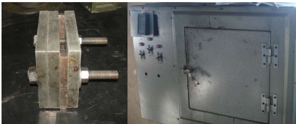
Figura 4.11. Dispositivo de compresión y horno utilizado en el ensayo.
