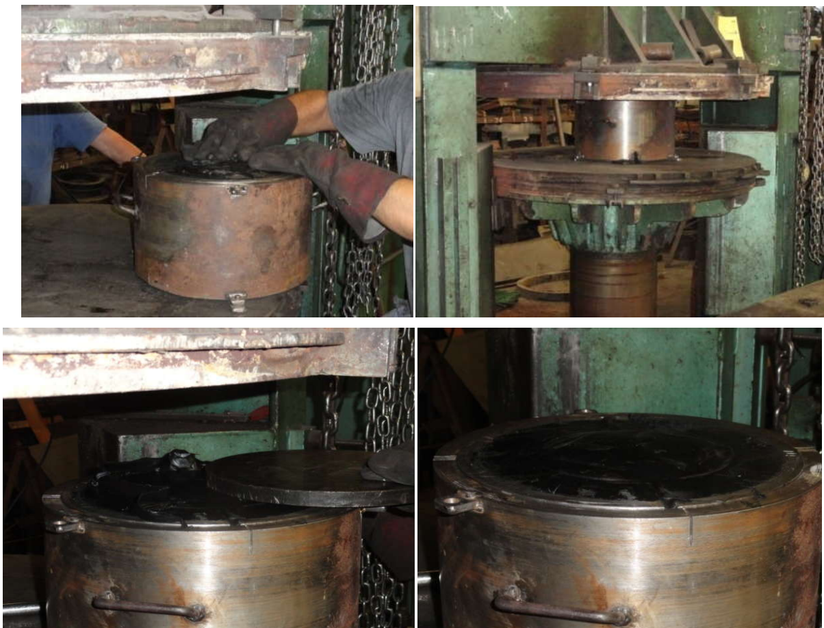
Figura 4.20. Fotografías durante el proceso de vulcanizado de los prototipos.
