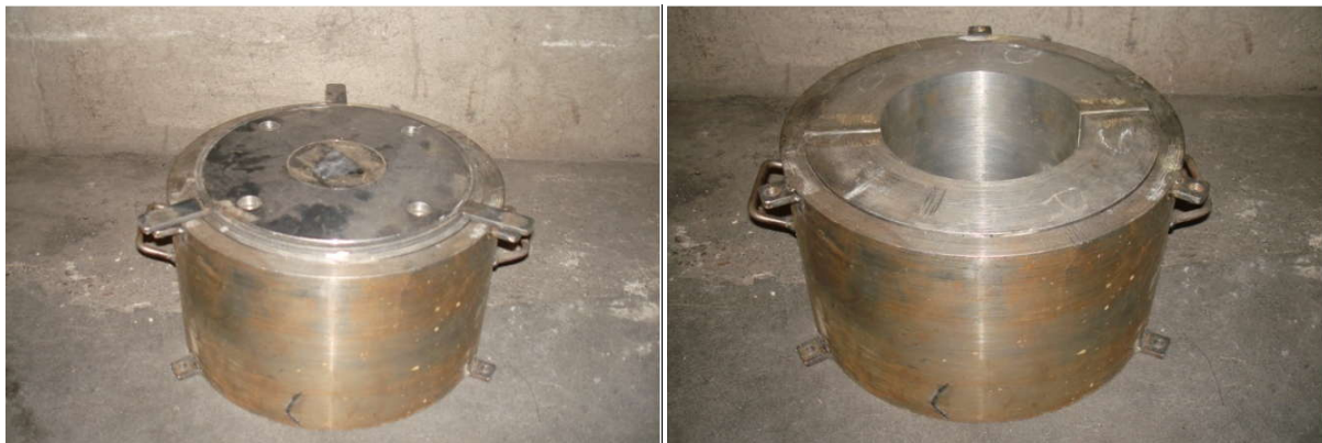
Figura 4.16. Fotografías de los moldes, las pletinas de conexión y el anillo de centrado.
