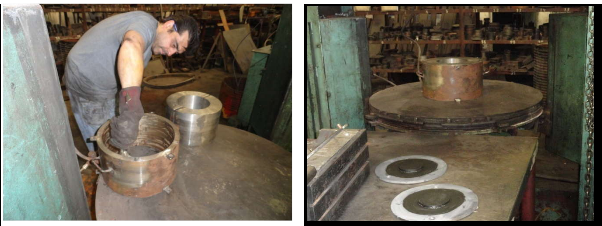
Figura 4.18. Fotografías de la colocación de aditivos en moldes y adhesivo en las pletinas.
