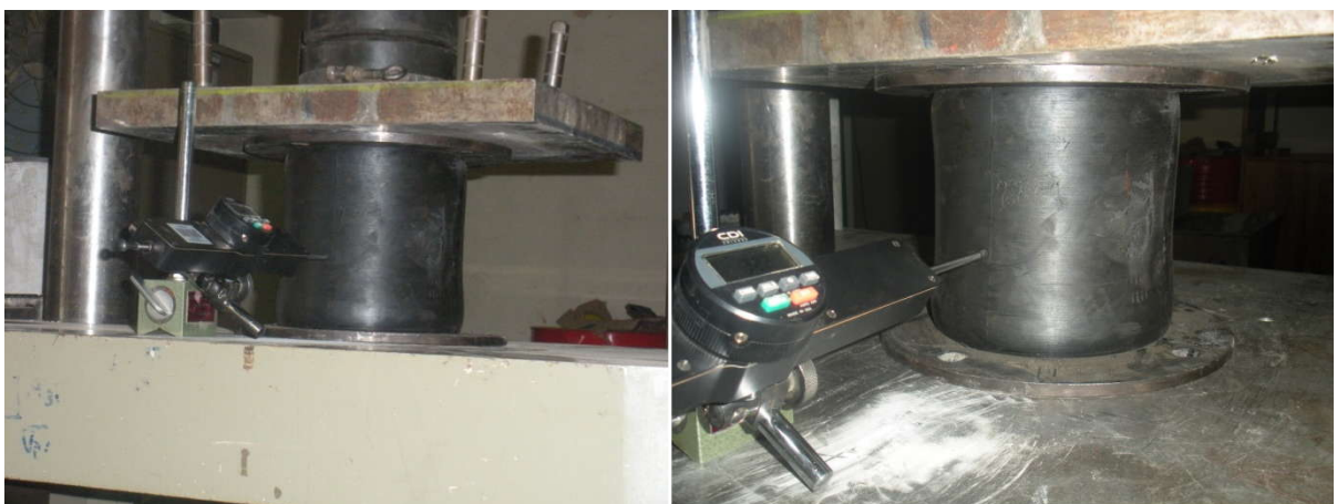
Figura 5.3. Fotografías del ensayo a fuerza axial vertical al prototipo ANAG-1.
