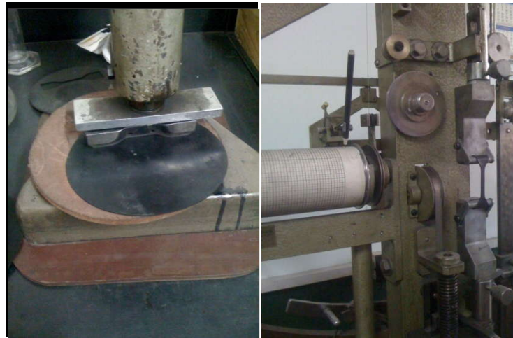
Figura 4.10. Probeta tipo Dumbbell y la maquina dinamómetro.
