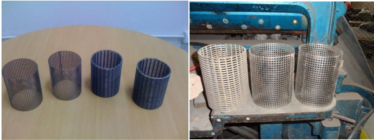
Figura 4.17. Fotografías de los núcleos colocados en los prototipos ANAG y ANAF.
