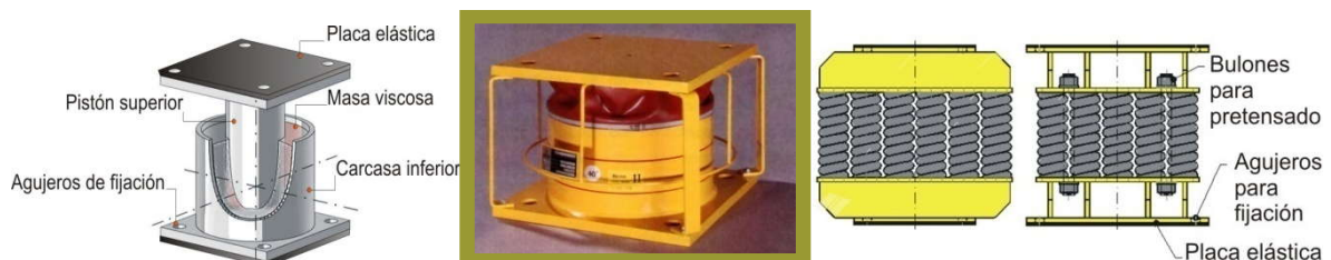
Figura 2.26. Paquete de resortes metálicos GERB y Amortiguadores viscoelásticos GERB (Visco®).
