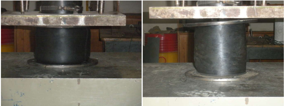
Figura 5.4. Fotografías del ensayo a fuerza axial vertical al prototipo ANAF-1.
