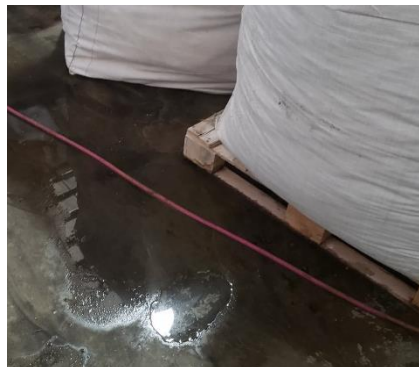
Materia prima desprende agua residual (formación de charcos)
