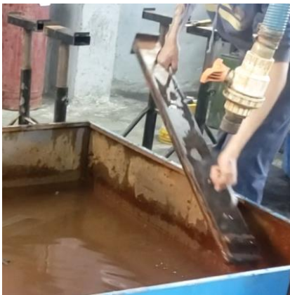
Extracción del molde desde la tina de enfriamiento (Izquierda) – Extracción del perfil (Derecha)
