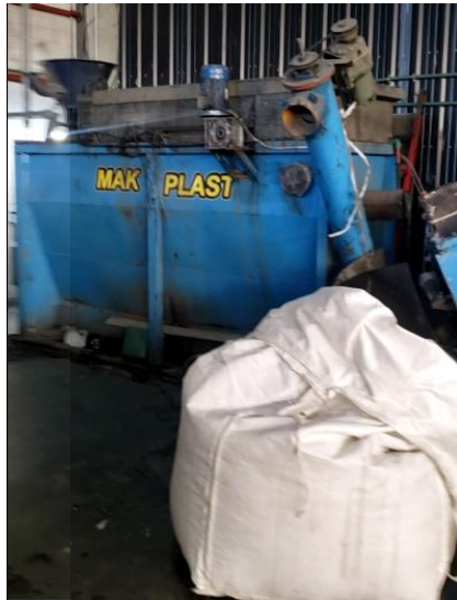
Tina para lavado de plásticos rígidos (Izquierda) – Salida de la materia limpia (Derecha)
