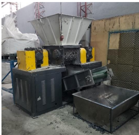
Molino doble eje para películas plásticas (Izquierda) - Retazos de LDPE (Derecha)
