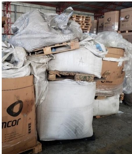
Apilamiento inestable (Izquierda) – Rotura y desmoronamiento de material (Derecha)
