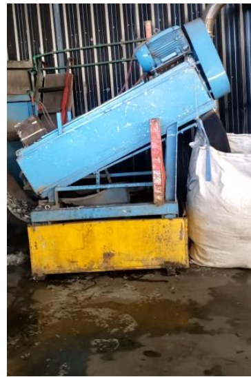
Tina para lavado de plásticos rígidos (Izquierda) – Salida de la materia limpia (Derecha)
