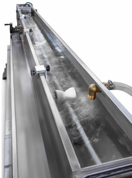
Funcionamiento básico del producto Teknomast VR3000 “Bañera de enfriamiento por inmersión”. Se puede observar cómo se somete a enfriamiento por inmersión a una tubería de plástico PVC
