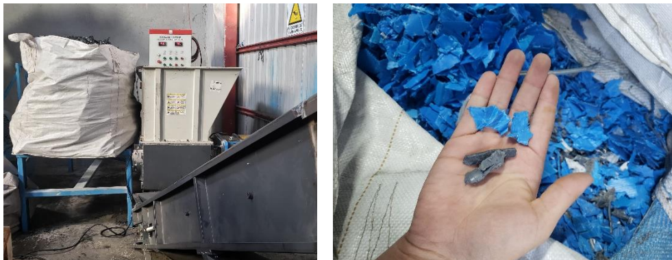
Molino mono eje para plásticos rígidos (Izquierda) – Escamas plásticas (Derecha)
