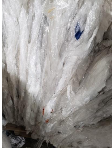
Fardo prensado de film LDPE (Izquierda) – Film LDPE segregado / clasificado (Derecha)
