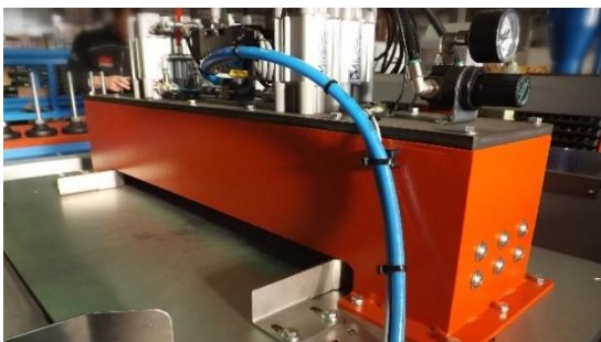
Ejemplo sobre el mecanismo de corte, de la UCA (unidad de corte) TG VTS 350.
