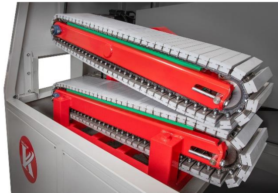
Ejemplo de funcionamiento en una Unidad de Arrastre por sistema de orugas
