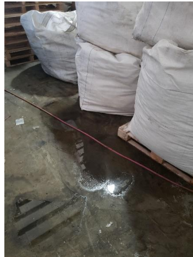
Ciclón (Izquierda) - Material húmedo genera charcos de agua en el suelo (Derecha)
