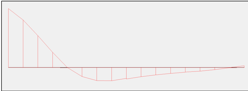
Anexos-Figura 11 – Diagrama de corte en base de tabique submural.
