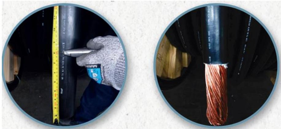
*Ilustración 129. Extracción de cubierta externa*
