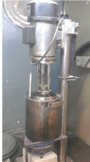
Se realizó la dispersión incorporando polvo de neumático al asfalto, previamente calentado, en la cuba inferior durante 5 minutos, con un tiempo total de operación del equipo de 60 minutos, manteniendo una velocidad de elaboración entre 7000-7500 RPM y temperatura de 180-190 °C. Posteriormente, se determinó la penetración, punto de ablandamiento y viscosidad rotacional a 135 °C y 170 °C del asfalto modificado. Estas mediciones permiten evaluar las algunas propiedades y el grado de modificación.
