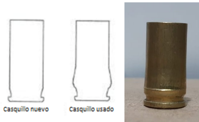
Fig. 1- Deformación del casquillo. Elaboración Propia
