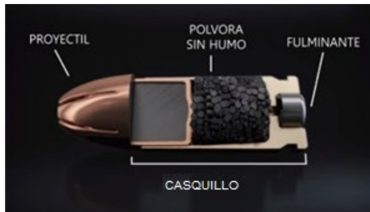
Fig. 3 - Detalle de la conformación de una munición. Elaboración Propia
