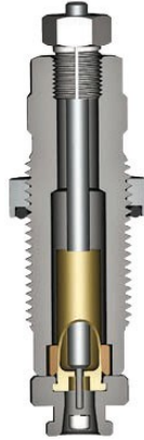
Fig. 16 - Die de rectificación utilizado en una máquina de recarga. Elaboración propia.
