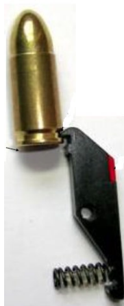
Fig. 13 - Uña extractora en su posición de trabajo. Elaboración propia
