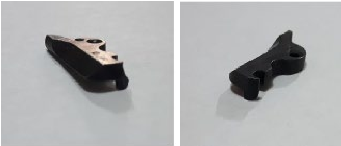
Fig. 14 Comparación de Uña Extractora rota y una nueva. Elaboración Propia.
