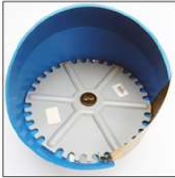
Fig. 22 - Case feeder o alimentador de casquillos. Elaboración propia.
