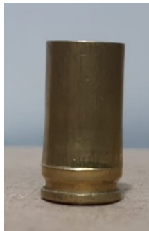
Fig. 12 - Casquillo deformado debido al ensayo realizado. Elaboración propia
