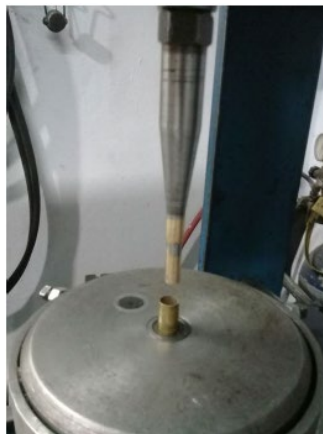
Fig. 17 - Punzonadora neumática para restaurar casquillos casera. Elaboración propia
