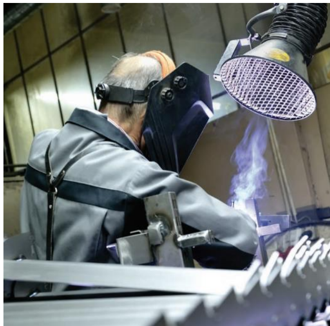
Figura 5.12: brazo de aspiración en el origen. (Plymovent, 2024)
