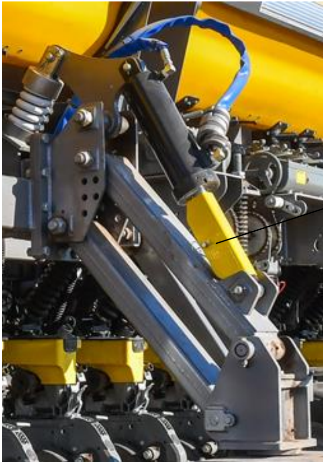
Figura 6.14: medida de seguridad, tope de cilindro para transporte. (PLA, 2023)
