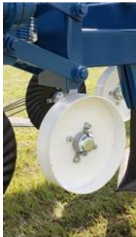
Figura 2.11: rueda totalmente rígida con alma y aro exterior de acero. (Agrofy Market, n.d.)
