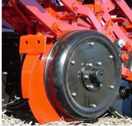
Figura 2.10: rueda con alma de chapa y aro exterior de goma. (Clarín, 2018)
