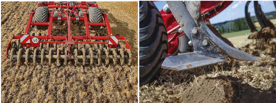
Figura 1.12: Cultivador de reja Horsch. (HORSCH Maschinen GmbH, 2020)
