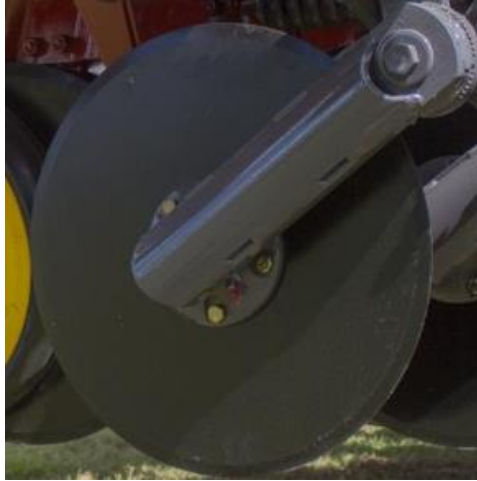
Figura 1.8: sistema de corte vertical con regulación de profundidad. (Demagro SRL, 2022)
