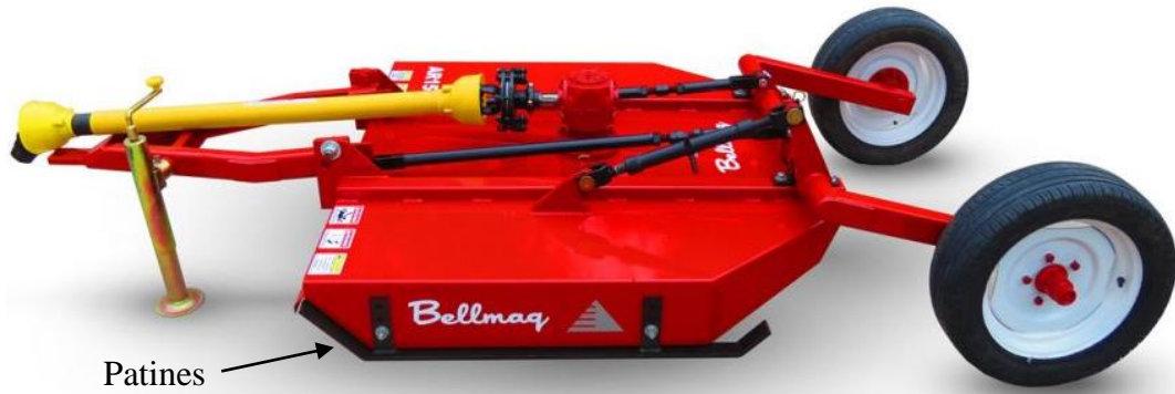
Figura 2.9: desmalezadora con copiador de terreno por rozamiento. (Bellmaq, 2021)
