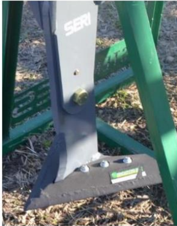
Figura 1.7: reja plana montada sobre timón por medio de bulones. (Agroseri SRL, 2018)
