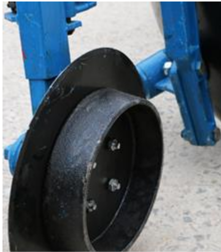
Figura 2.12: rueda totalmente rígida con disco central.
