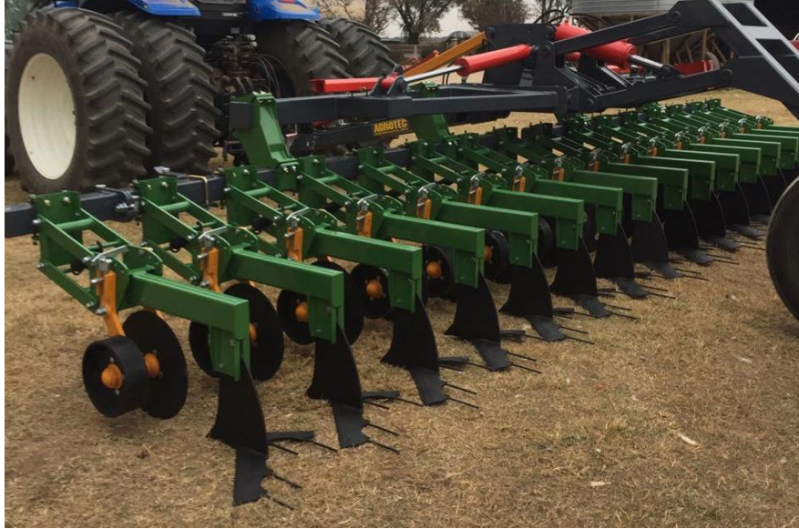
Figura 1.20: Control mecánico de malezas Carpitec. (Agrotec, 2021)
