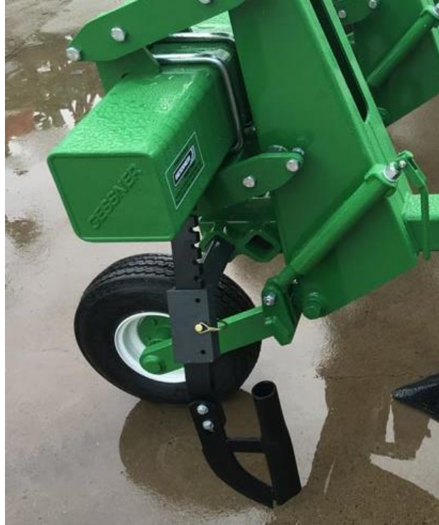
Figura 2.13: neumático inflable para copiado de terreno. (Gessner, n.d.)
