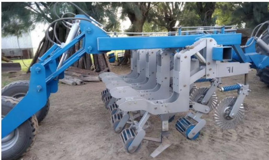
Figura 1.17: Sistema de Industria Fragar SA. (Maquinac, Fragar desarrolló una máquina para el control mecánico de malezas, 2019)
