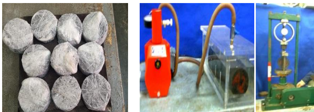
Figura 11. Acondicionamiento de probetas y ensayo de resistencia a daños por humedad inducidos
