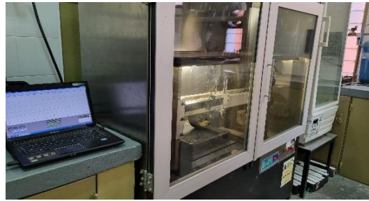
Figura 12. Probetas y ensayo de ahuellamiento WTT.
