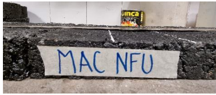
Figura 12. Probetas y ensayo de ahuellamiento WTT.
