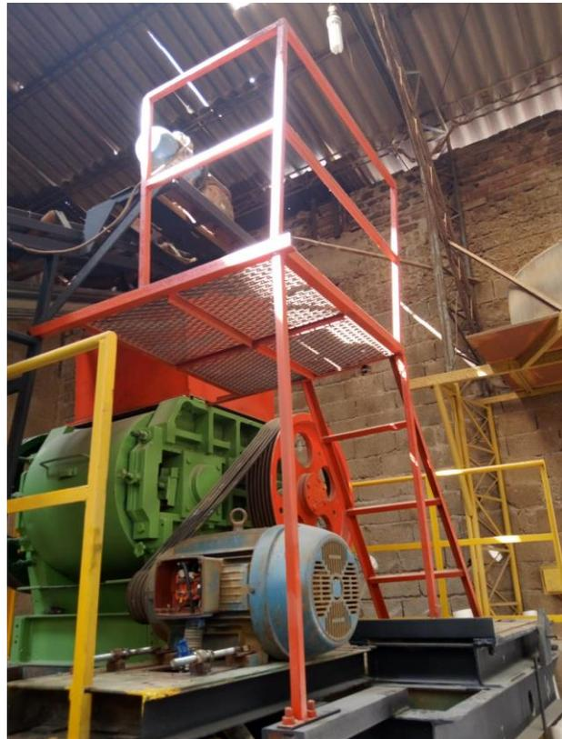
*Imagen 17. Escalera de maquinaria con faltantes de protecciones de seguridad.*
