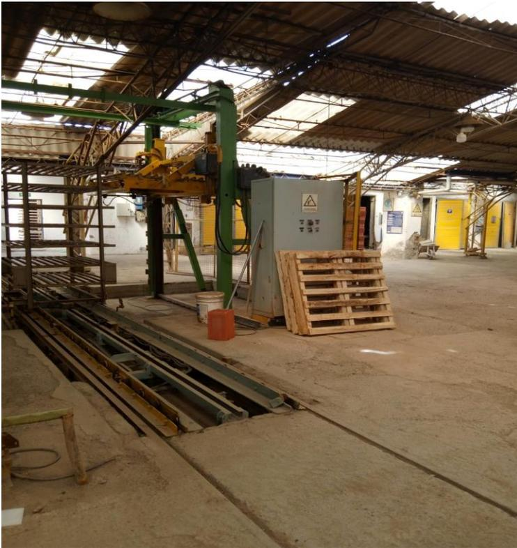
*Imagen 18. Falta de demarcación del área de trabajo, falta de orden y limpieza.*
