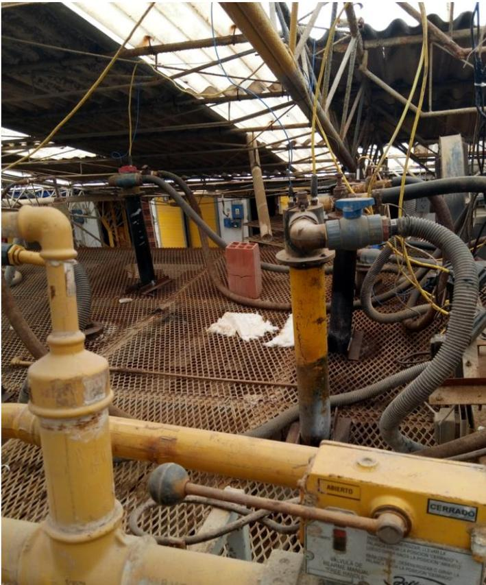
Imagen 20. Material inflamable arriba del horno.
